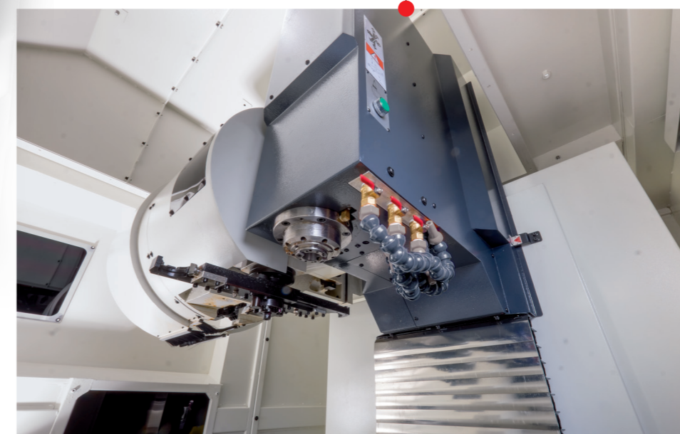
Werkzeugwechsler mit Doppelgreifer
