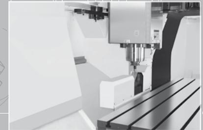
Optionales Lasersystem für Werkzeugvermessung unter automatischer Schutzhaube
