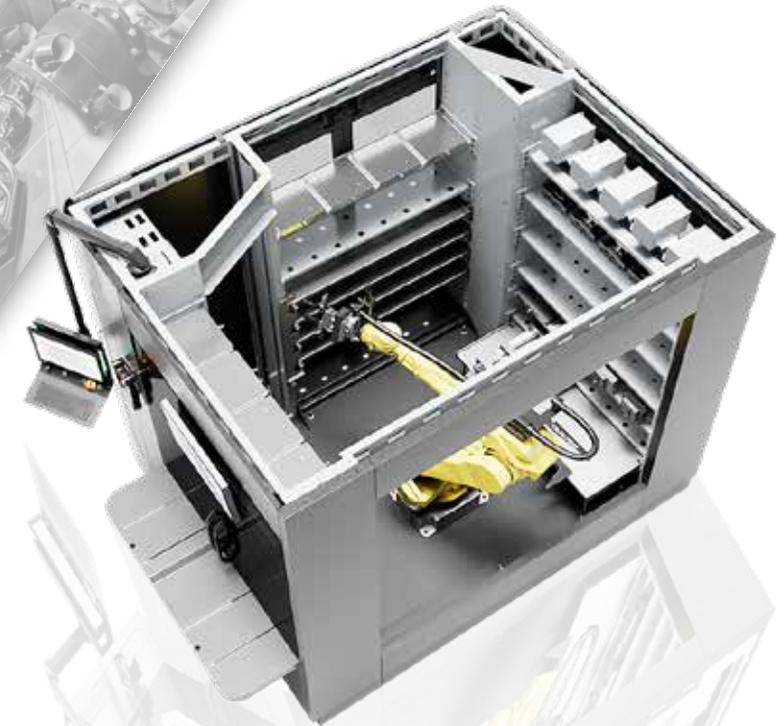
Die bewährten Linearachsroboter Productionline 200 und 500 sind das Herzstück der Rundspeichersysteme. Durch die radial angeordneten Regalmodule kommen die Anlagen ohne Bodenfahrwerk aus und bieten bei kompakter Stellfläche viel Raum für schwere Werkstücke.
