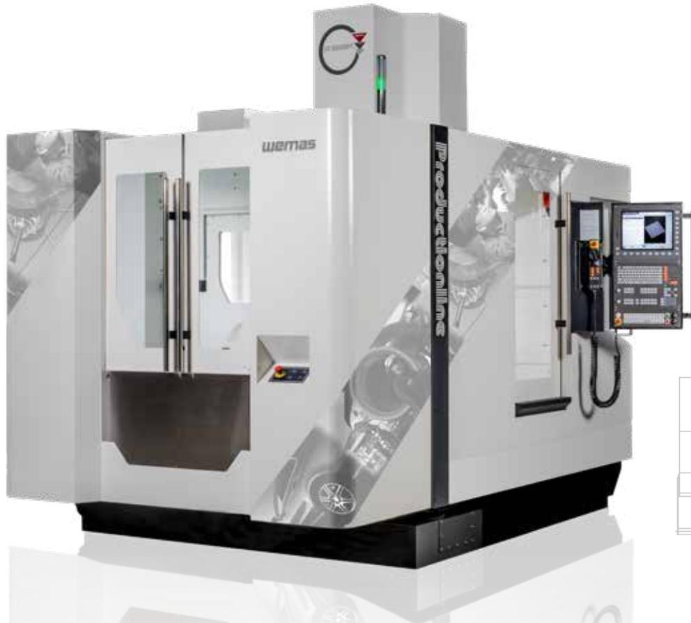
**Im Fokus der Entwicklung der Zentren VZ PRODUCTIONLINE** steht die maximale Erhöhung der Maschinenproduktivität. Die Grundmaschine basiert auf der bewährten Konstruktion der VZ Baureihe und bietet deren Vorteile und zusätzliche innovative Features. Durch den integrierten Palettenwechsler erweitert sich der Einsatzbereich auf die wirtschaftliche und effektive Produktion von Klein- und Großserien.
