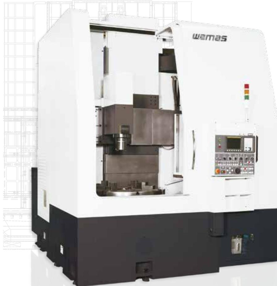
Als Gegengewicht zu den klassischen horizontalen Schrägbettmaschinen eignen sich die **WEMAS Vertikaldrehmaschinen der Baureihe VDZ** vorrangig für die Drehbearbeitung von großen Werkstücken mit ungünstiger Relation des Durchmessers und der Länge. Die horizontale Lage des Spannfutters ermöglicht
