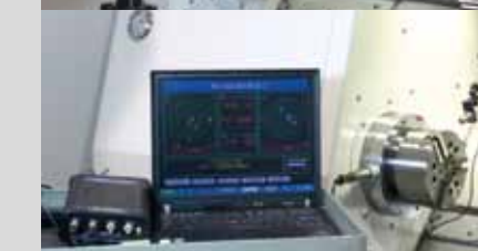
Dynamisches Wuchten der Spindel
